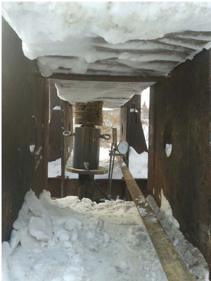
Фото 12. Испытательное оборудование для испытания грунтов штампом с плоской подошвой площадью 124,6 см 2
