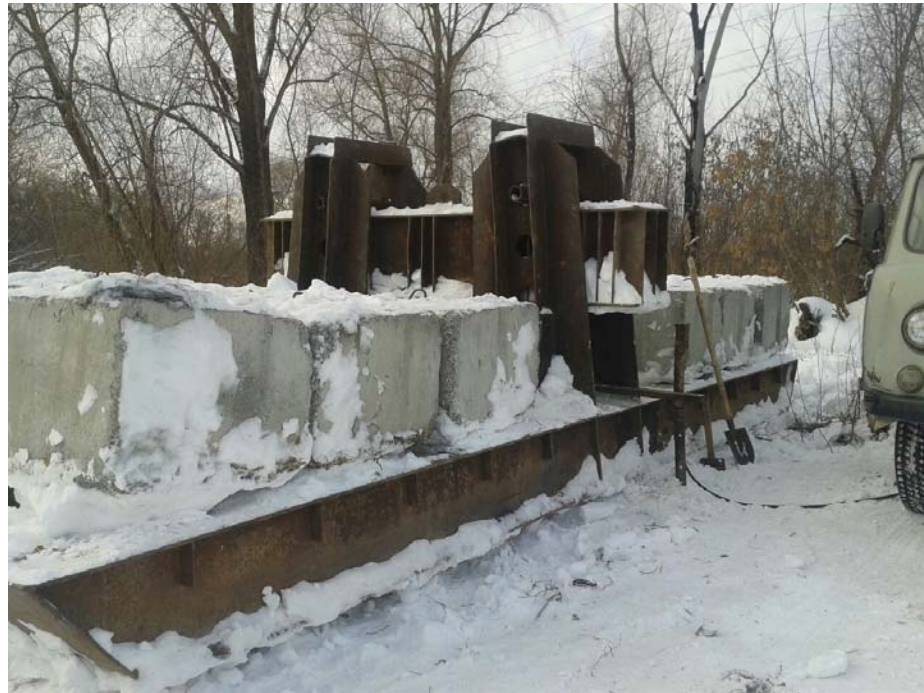
Фото 13. Балластный груз для испытания грунтов штампом с плоской подшовой площадью 124,6 см 2
