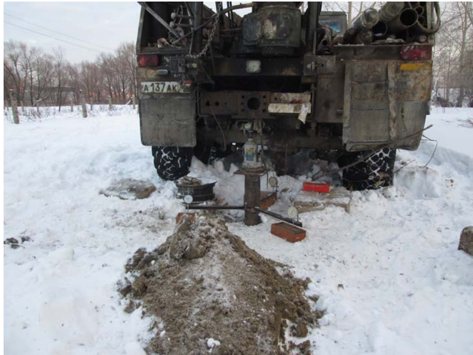
Фото 9. Испытания грунтов винтовым штампом
